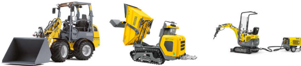
Figur 4: Elektriske anleggsmaskiner fra Wacker Neuson. Fra venstre: batteridrevet hjullaster (2,35 tonn), batteridrevet dumper (1 tonn) og elektrisk gravemaskin (1 tonn, «dual power» som kobles til ekstern elektrisk motor)
