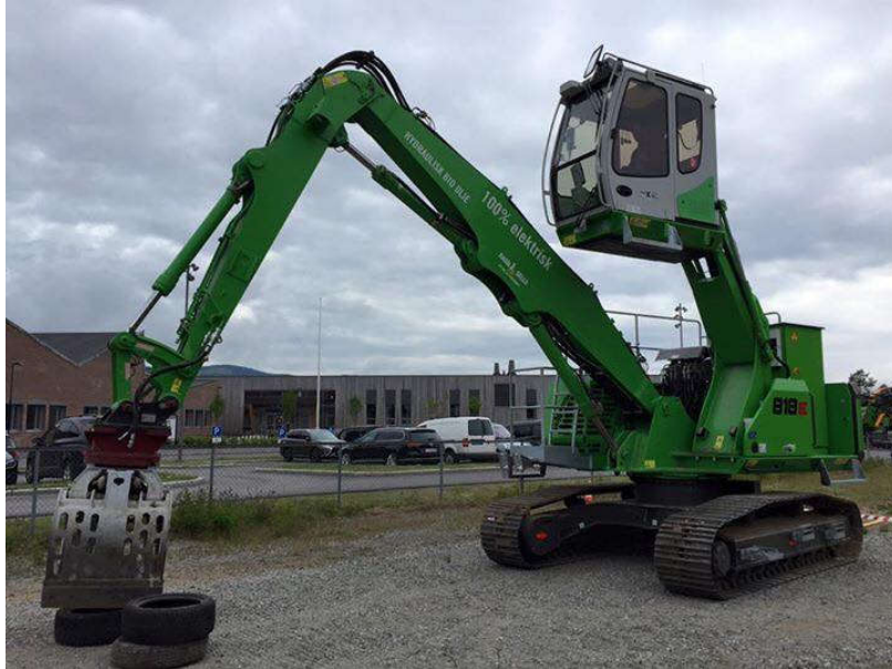
Figur 5: Elektrisk sorteringsmaskin fra Sennebogen (818E på 22 tonn). Bilde fra Ragn Sells
